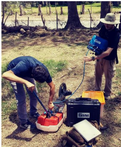
APLICACIÓN DEL GEO-RADAR; AGUA CALIENTE, AR, SECTOR NORTE, 27 DE MARZO 2019
